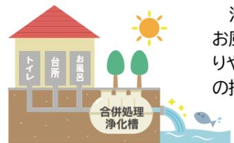
浄化槽(合併処理浄化槽)は、下水道と同じようにトイレ・台所・お風呂などから出る汚れた水をきれいにする設備です。くみ取りや単独処理浄化槽は、生活雑排水(台所、お風呂、洗濯等の排水)は処理できないため水質汚染の原因になります。
